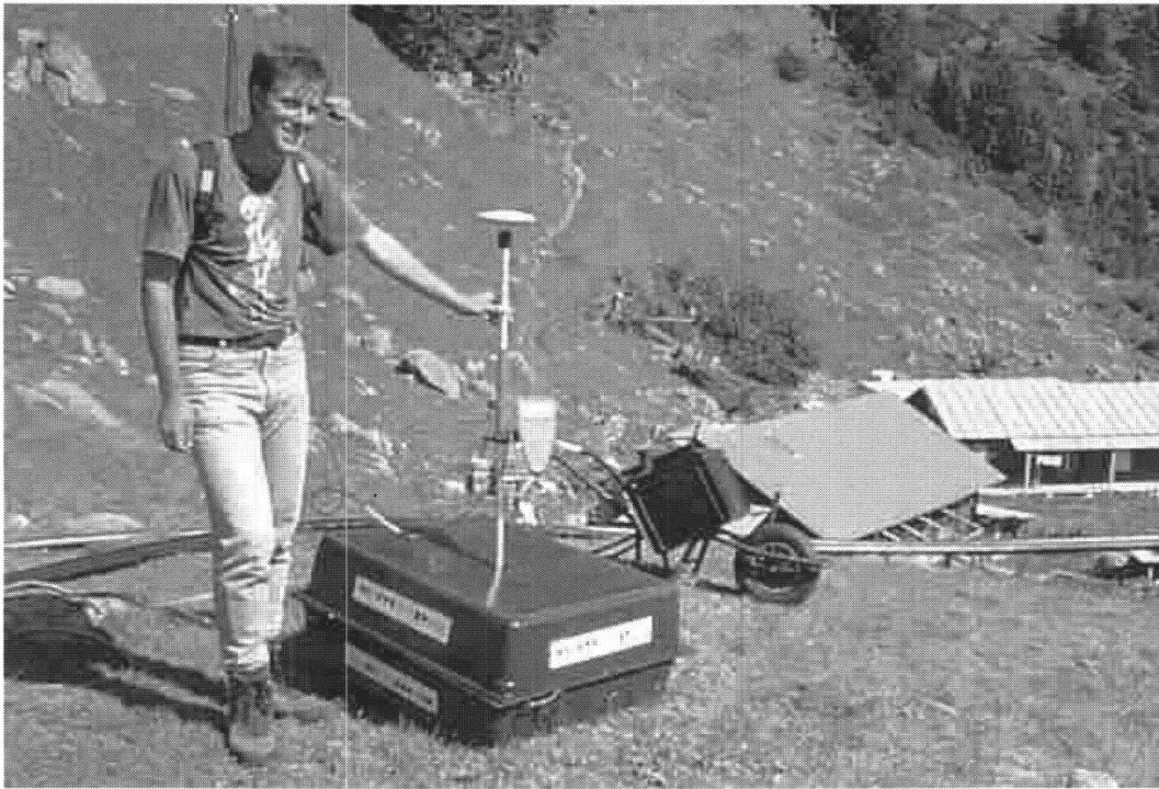
Fig. 5: Positionierung der Georadarantennen mit differentielltem GPS beim Bergsturzgebiet Chapf, Innertkirchen (ETH Zürich, Geodätischer Projektkurs).
