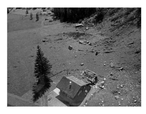
Fig. 8: Streufeld der Grossblöcke mit wassergefüllten Einschlagtrichtern.
