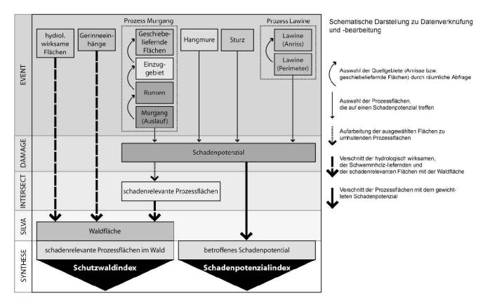
**Fig. 5:** Schematische Darstellung der einzelnen Arbeitsschritte in SilvaProtect-CH und der Datenverknüpfung/-bearbeitung im Modul INTERSECT.
