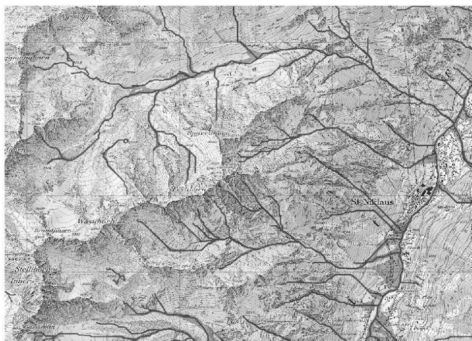
Fig. 4: Gefahrenperimeter des Prozesses Murgang. Runsennetz (dunkelgrau) und Murgangablagerungsflächen auf den Schwemmkegeln (grau).
