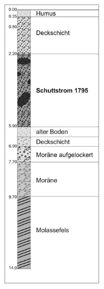
**Fig. 7:** Bohrprofil (vereinfacht) im Kegelhalsbereich des Schuttstromes.
