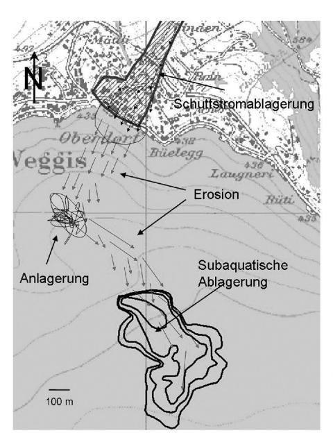
**Fig. 13:** Fliesspfad der Rutschmasse und deren Ausmass (Äquidistanz der Ablagerungskurven: 0.7 m) mit einer Kubatur von ca. 140'000 m<sup>3</sup>.
