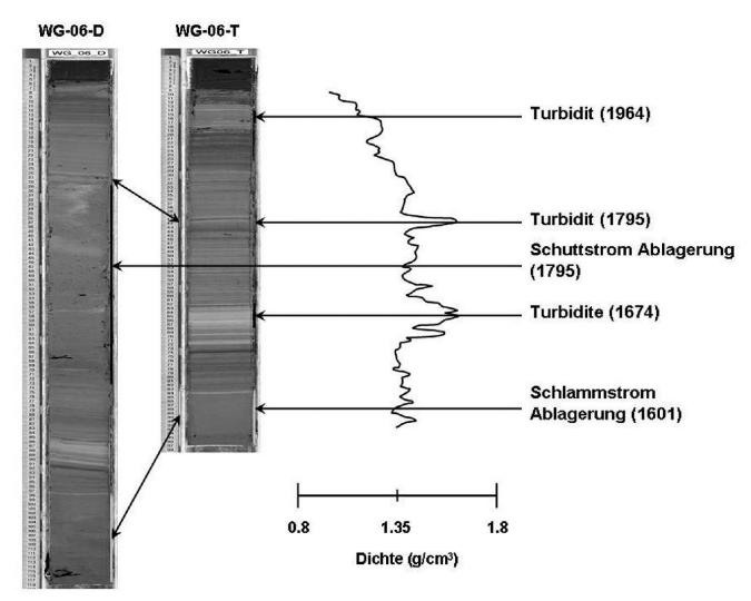
Fig. 12: Die im distalen Bereich gelegenen Kerne WG-06-D und WG-06-T und das Dichteprofil von WG-06-T.
