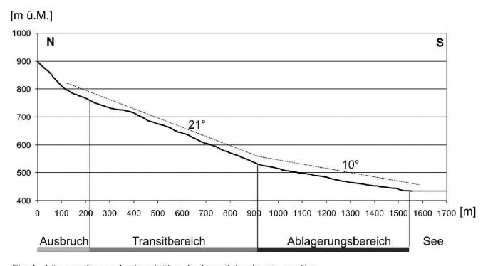
Fig. 6: Längsprofil vom Ausbruch über die Transitstrecke bis zum See.
