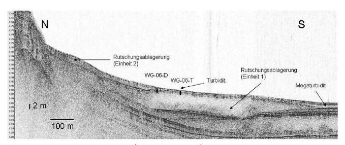
**Fig. 11:** Seismisches Profil vor Weggis (Profilspur in Fig. 10) mit den beiden Rutschungsablagerungen (Einheit 1 und 2) und den entnommenen Kurzkernen WG-06-D und WG-06-T.
