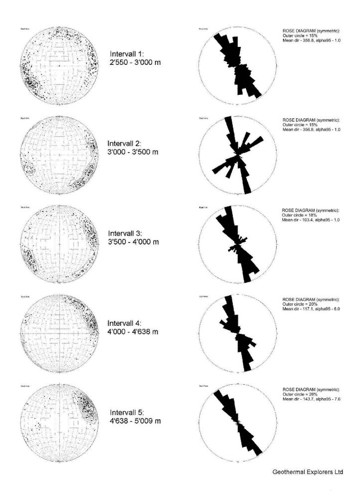
**Fig. 4:** Trennflächenanalyse für angegebene Tiefenintervalle. Links sind die Flächenpole dargestellt [flächentreues Netz, untere Halbkugel]. Rechts ist das Streichen der Trennflächen als Rosendiagramm dargestellt.
