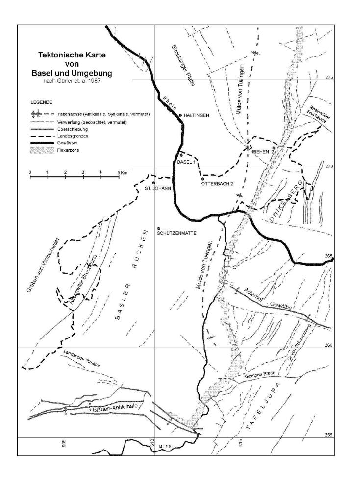
**Fig. 2:** Tektonische Übersichtskarte mit der Lage der seismischen Beobachtungsstationen und der Geothermiebohrung Basel 1. Für die Ortung der induzierten Ereignisse wurden die Bohrungen Haltingen, Otterbach 2, Riehen 2, St. Johann und Schützenmatte verwendet.
