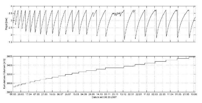
Fig. 5: Pegelstandsmessungen und kumulatives Wasservolumen, das seit dem Abbruch der Stimulation zurückgeflossen ist. Der Pegelstand wird mit einer Druckmesssonde gemessen, die sich in einer Tiefe von 33 m unter OKT befindet und automatisch den Druck der darüber liegenden Wassersäule misst. Beim Erreichen eines Druckes von 3.7 bar fängt die Bohrung an Wasser «auszuspucken».
