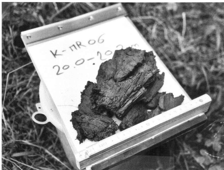
Fig. 5: Holzprobe c aus Bohrung 6 aus 20.0-20.2 m Tiefe.
