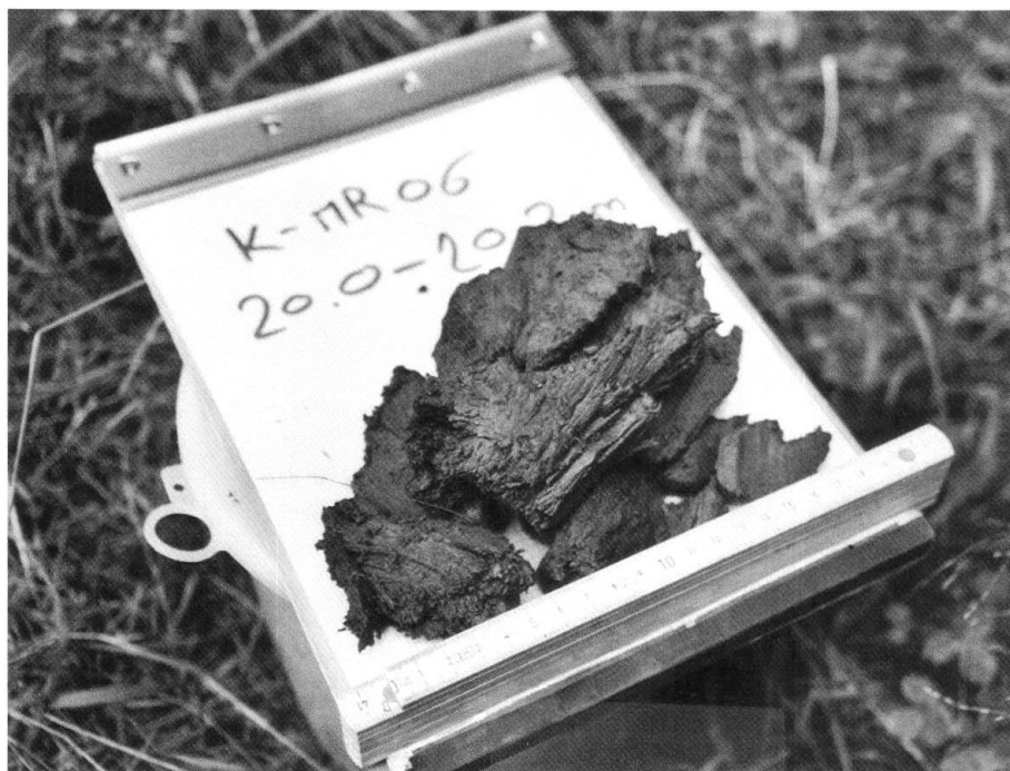
Fig. 5: Holzprobe c aus Bohrung 6 aus 20.0-20.2 m Tiefe.
