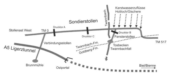
Fig. 7: Situation des Sondierstollens für den Umfahrungstunnel Twann (sehr schematisch, nicht massstäblich).
