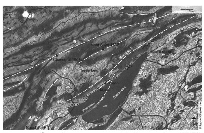
Fig. 1: Allgemeine Übersicht (Satellitenbild reproduziert mit Bewilligung von swisstopo BA081039). Gepunktete Linie: Nationalstrasse A5 (durchschnittlicher täglicher Verkehr im Jahre 2005: 13'700 Fahrzeuge; Tendenz steigend, vor allem nach der zukünftigen Inbetriebnahme der Umfahrung Biel). Strichpunktiert: Ligerztunnel; durchgezogen: Twanntunnel; weiss gestrichelt: wichtigste Antiklinalen.
