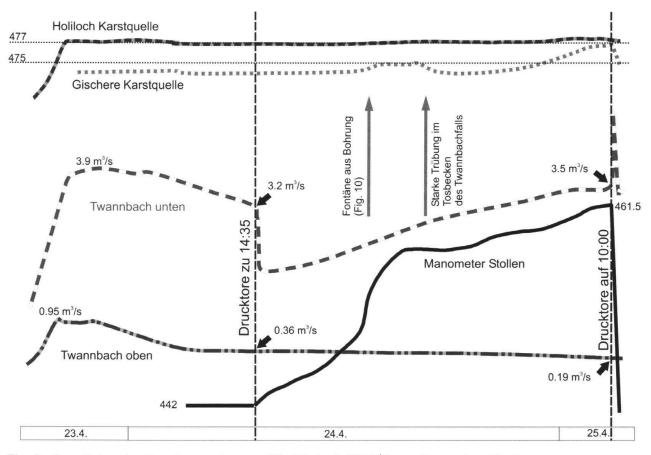
**Fig. 9:** Ganglinien des Druckversuchs vom 24.-25. April 1990 (Darstellung ohne Skalierungen; gemessen wurde in folgenden Masseinheiten: Karstwasserspiegel für Holiloch und Gischere in m ü. M., m³/s für die Abflüsse im Twannbach, Druckniveau im Stollen in m ü. M.).
