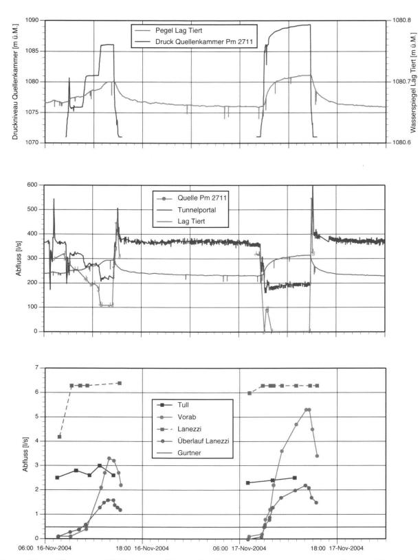
**Fig. 2:** Die im November 2004 durchgeführten Druckversuche zeigen klar, dass der Lag Tiert bei Verschluss des Tunnels stärker fliesst (obere und mittlere Grafik), und auch viele Quellen im Dorf sprechen an (untere Grafik).
