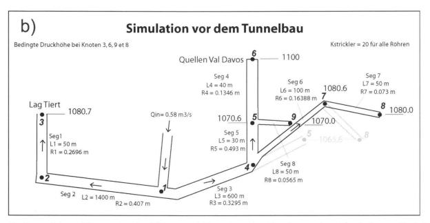
**Fig. 3:** Geometrie und Parameter des Röhrenmodelles. a) vor den Druckversuchen, b) mit diesem Modell kann die Situation vor dem Tunnelbau simuliert werden.
