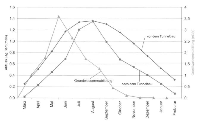
Fig. 5: Ergebnisse des Tankmodelles. Vor dem Tunnelbau ist der Speicher gross genug, um einen minimalen Abfluss von 200 l/s zu gewährleisten. Nach dem Tunnelbau ist der Speicher nicht mehr gross genug, um eine kontinuierliche Schüttung im Winter zu gewährleisten.
