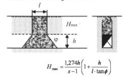
schlotartiger Hochbruch mit senkrechten Bruchflächen über Flächenabbauen ohne seitliche Begrenzung für den Bruchmassenkegel (Verbruchform: Zylinder)
