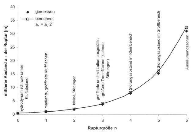
Fig. 6: Abhängigkeit des mittleren Rupturabstandes einer statistisch ermittelten Trennflächenschar (bc-Kluft) von der Rupturgrösse (modifiziert nach Meier 1978b).
