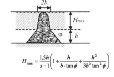
**Fig. 4:** Hohlraum-Bruchmassen-Bilanz-Modell nach G. Meier (1978a). Parameterbezeichnung: b = halbe Breite des Bruchschlotes, l = Breite des Bruchschlotes,  $h = H\ddot{o}he$  des Hohlraumes, s = Auflockerungsfaktor (Schüttungszahl),  $\phi = innerer$  Reibungswinkel der Bruchmassen.
