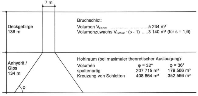
**Fig. 10:** Schematischer Schnitt durch den Erdfall auf der B 180 mit maximalen Hohlraum-Bruchvolumen-Bilanzen.
