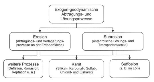
Fig. 5: Schema zu den exogen-geodynamischen Abtragungs- und Lösungsprozessen.
