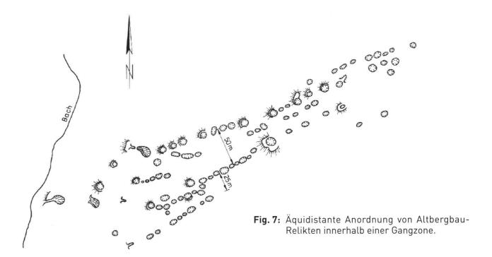
Die perlschnurartige Anordnung der Schachtpingen und Tagesbrüche widerspiegelt hier den jeweiligen Gangverlauf entsprechend der ausgebildeten Rupturgrösse. Die Abstände der einzelnen Gänge verhalten sich nach den oben aufgeführten numerischen Beziehungen der Äquidistanz. Für den Gangerzbergbau ergibt sich daraus auch der Zusammenhang, dass im Lagerstättenbe-
