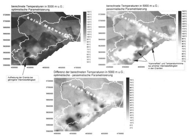
**Fig. 4:** Vergleich der berechneten Temperaturen in 5000 m Tiefe bei unterschiedlichem Parameteransatz (links oben: «optimistischer», rechts oben: «pessimistischer» Parameteransatz, unten: Temperaturdifferenz beider Modelle).
