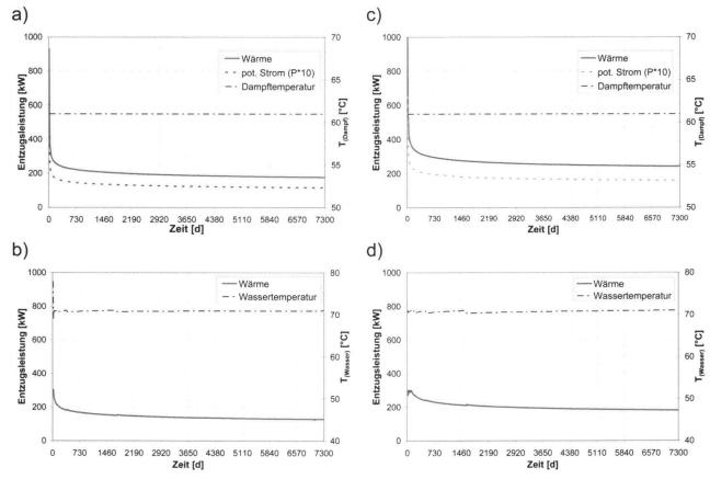
**Fig. 5:** Leistungsprognose für tiefe Erdwärmesonden an zwei Modellstandorten im Freistaat Sachsen (Modellstandort 1: a) NH<sub>3</sub> und b) H<sub>2</sub>O sowie Modellstandort 2: c) NH<sub>3</sub> und d) H<sub>2</sub>O). [5000 m Sondenlänge, 0,17 m Sondendurchmesser, 61°C Systemtemperatur und 20 Jahre Volllastbetriebsdauer].
