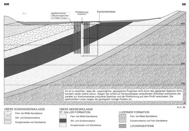
**Fig. 3:** Geologisches Prognoseprofil mit der Lage des geothermischen Diffusionsspeichers und Vergleich mit der in das Profil projizierten Pilotbohrung.
