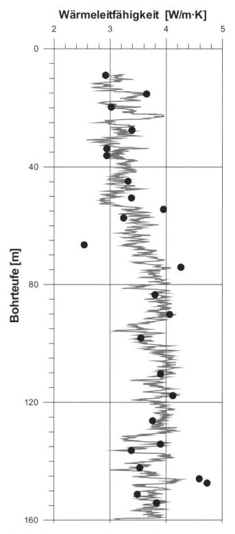
Fig. 7: Graph der aus den geophysikalischen Logs (Fig. 4) bestimmten Wärmeleitfähigkeiten in Relation zur Bohrtiefe und im Vergleich zu den Laborwerten (schwarze Punkte). Ausgehend von einem Mittelwert von 3.6 W/m·K sind zwei Abschnitte erkennbar: OK Fels bis 53 m mit einem geometrischen Mittel der Wärmeleitfähigkeit von 3.2 W/m·K und von 53-160 m mit einem solchen von 3.7 W/m·K.
