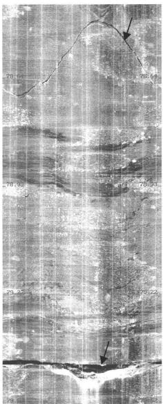
Fig. 5: Abgewickelte, orientierte Bohrloch-Scans der Tiefenintervalle 14.0-15.1 m (links) und 78.5-79.5 m (rechts). Deutlich sichtbar sind die feinen offenen Klüfte (Pfeile). Die Kluft bei 79.4 m (im rechten Ausschnitt unten) ist scheinbar mehrere Millimeter geöffnet.
