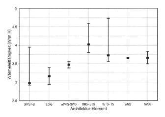
Fig. 6: Vergleich der im Labor ermittelten Wärmekapazitäten, der Wärmeleitfähigkeiten und der Nutzporositäten für verschiedene Architektur-Elemente.
