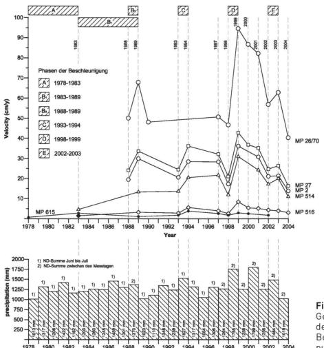
Fig. 9: Geschwindigkeiten und Niederschlagssummen (ND) am Beispiel ausgewählter Messpunkte (MP).
