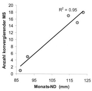
**Fig. 11:** Zusammenhang zwischen Monats-Niederschlag (ND) und der Anzahl konvergierender Messstrecken MS (n = 5, p < 0.01).
