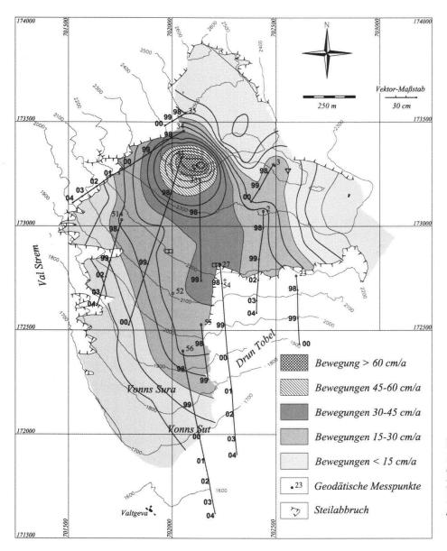
Fig. 5: Linien gleicher Bewegungsintensitäten (1999-2002) sowie ausgewählte Bewegungsvektoren mit Angaben zum Messjahr.
