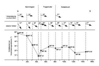
**Fig. 7:** Einfallsrichtung der Verschiebungsvektoren entlang eines N-S-Profils.
