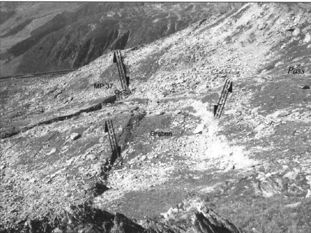
Fig. 3: Nackental und Grabenstruktur im Norden der Instabilität.
