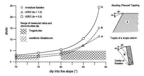
Fig. 13: Verhältnis zwischen horizontalem (dh) und vertikalem (dv) Bewegungsvektor bei verschiedenem Einfallwinkel gegen die Böschung.
