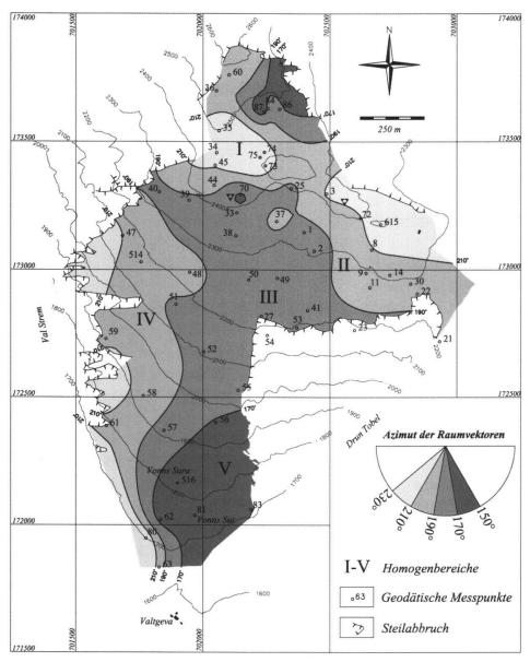
**Fig. 6:** Bereiche gleicher Verschiebungsrichtungen.
