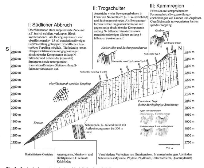
Fig. 2: Geologisch-geotechnisches Modell der Instabilität.
