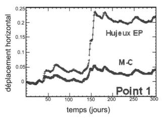
Fig. 9: Résultats de modélisation comparée des mouvements d'un point du glissement, selon la loi constitutive considérée dans le modèle géomécanique (M-C: Mohr-Coulomb).
