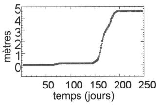
Fig. 8: Evolution du mouvement horizontal d'un point dans la partie inférieure du glissement de la Frasse, pendant la crise de 1993-94. Le déplacement réel mesuré au voisinage de ce point a atteint 3.2 m, au bord de la route cantonale, mais il est réduit par la présence d'une paroi de pieux soutenant la chaussée, qui n'est pas prise en compte dans le modèle.
