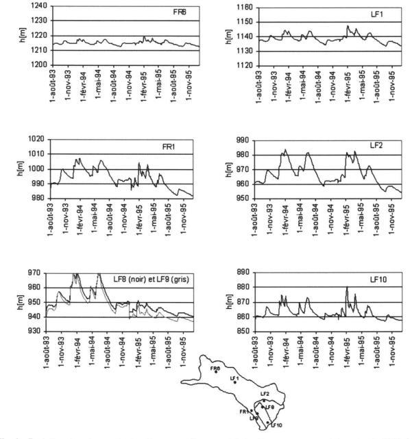
**Fig. 6:** Evolution des charges hydrauliques au glissement de La Frasse, au cours de la crise de 1993-94, en divers points du glissement.
