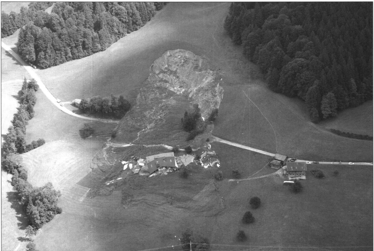
Fig. 2: Die Rutschung Feldweid. Situation am 23. August 2005 (Foto Schweizer Luftwaffe). Die Rutschung zerstörte die Scheune und das Wohnhaus der Liegenschaft Feldweid, die Renggstrasse wurde talwärts geschoben. 2006 brach eine weitere Rutschscholle ab. Sie riss im Wald, seitlich zur Anbruchsnische von 2005, rechts oben im Bild, ab.
