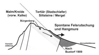
Fig. 8: Geologisches Profil durch den Bürgenstock gemäss Buxtorf. In den Kreideschichten der helvetischen Bürgenstock-Teildecke baut sich ein hoher Karstwasserdruck auf. Es wird davon ausgegangen, dass ein hoher Wasserdruck im Fels zum Abheben der obersten Felsschichten geführt hat. Die Wasserdrücke haben während des Ereignisses zu spürbaren untiefen Erdbeben in der Zentralschweiz geführt (Raum Alpnach, Raum Stans/Ennetbürgen, Raum Schüpfheim, Raum Riemenstalden und Muotatal).
