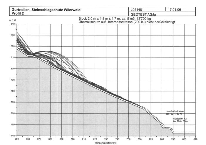
Fig. 10: Sturzsimulation Gurtnellen von Blöcken mit 5 m<sup>3</sup> Kubatur. Blöcke dieser Grösse können die Schutzbauten oberhalb der Autobahn überwinden und die Fahrbahn erreichen.
