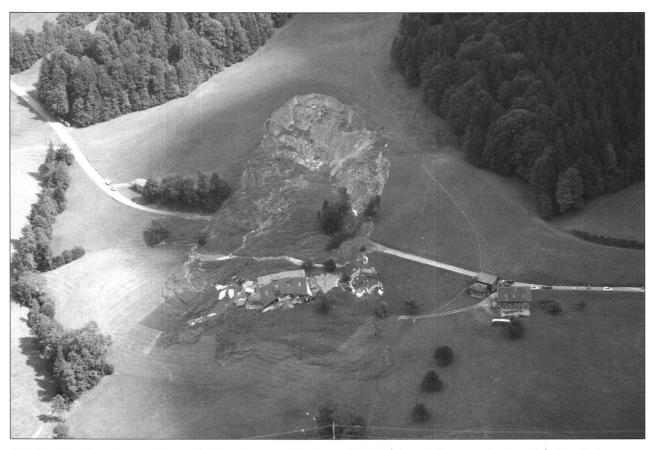
Fig. 2: Die Rutschung Feldweid. Situation am 23. August 2005 (Foto Schweizer Luftwaffe). Die Rutschung zerstörte die Scheune und das Wohnhaus der Liegenschaft Feldweid, die Renggstrasse wurde talwärts geschoben. 2006 brach eine weitere Rutschscholle ab. Sie riss im Wald, seitlich zur Anbruchnische von 2005, rechts oben im Bild, ab.
