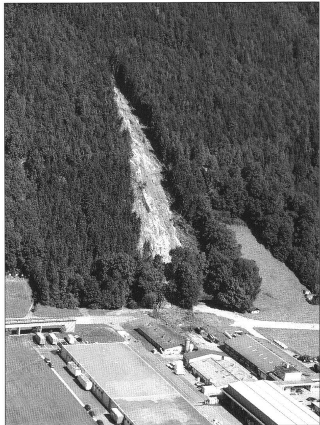
Fig. 5: Hangmure Herderenwald, Ennetbürgen (Ereigniskataster Nidwalden, Foto Oeko-B AG). Aufgrund von Karstwasseraustritten in noch nie beobachtetem Ausmass riss die Hangmure auf ihrem Weg zum Talboden die gesamte Lockergesteinsbedeckung auf der Felsoberfläche samt Wald mit.
