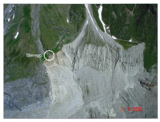
Fig. 4: Die grosse Rutschung Stieregg vom 29.5.2005 (660'000 m³) als Folge von Erosion durch Murgänge und abschmelzendem Toteis.
