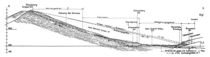
Fig. 3: Profilschnitt durch den Bergsturz von Goldau vom 2. September 1806 (Heim 1932).
