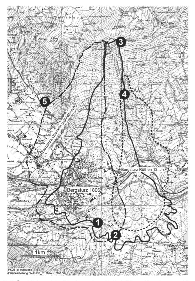
Fig. 7: Übersichtskarte mit den Exkursionsstandorten. Die Umrisslinien markieren die mutmasslichen Abriss-, Transit- und Ablagerungsräume folgender Bergstürze: Bergsturz von 1806 (ausgezogene Linie), Bergsturz von Röthen (gestrichelte Linie) und Oberarther Bergsturz (strich-punktierte Linie).
