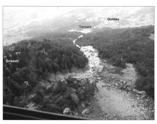
Fig. 7: Transitstrecke des murgangartig abfliessenden Schuttstroms. Dadurch wurde der zuvor geschlossene Wald auf einer Fläche von etwa 10 ha niedergewalzt (Foto: Kapo Schwyz).
