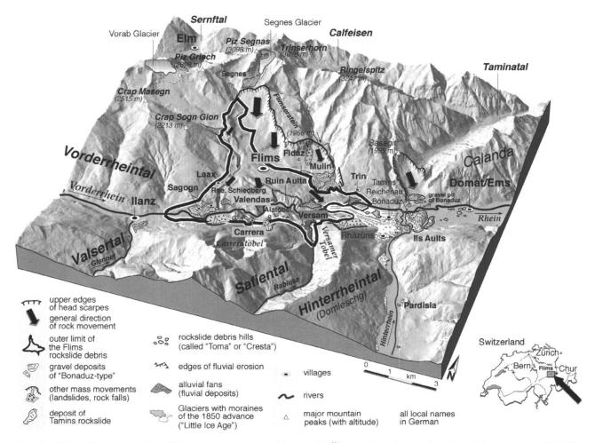
**Fig. 1:** Blockdiagramm des Flimser Bergsturzgebietes als Übersichtsskizze. Aus Poschinger et al. (2006). Die im Text erwähnten Rutschungen in den Bündnerschiefern liegen nordwestlich sowie nordöstlich des Schriftzuges «Carrera» sowie nördlich der Beschriftung «Rhäzüns».
