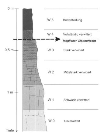
**Fig. 9:** Verwitterungsprofil der Mergel mit Klassifikation der Verwitterungsgrade nach Einsele et al. 1985 mit möglichem Gleithorizont.
