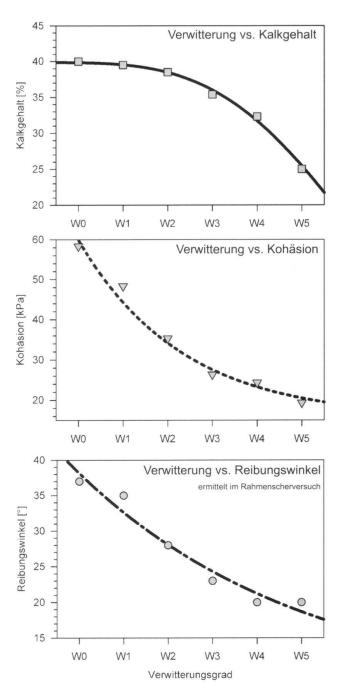
**Fig. 8:** Abnahme der Bodenkennwerte mit zunehmender Verwitterung.
