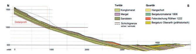
Fig. 6: Aktueller Längsschnitt durch die Gleitfläche des Bergsturzes von Goldau 1806 (Berner 2004).
