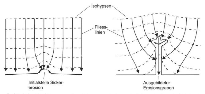
**Fig. 11:** Verlauf der Sickerwasser-Fliesslinien und der Isohypsen im Falle von beginnender (links) und fortgeschrittener (rechts) Sickererosion im Bereich eines Erosionsgrabens (nach Crosta & di Prisco 1999).
