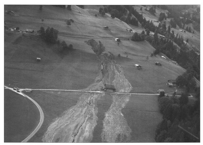
**Fig. 8:** Erosionsgräben (obere Bildmitte) und übermurtes Gelände im Gebiet Hanebüel-Riedere. Zwischen den beiden Hauptübermurungsflächen liegt ein Stall, der von den Erdmassen getroffen wurde. Die Strasse nach Walkli verläuft etwas unterhalb der Bildmitte. Luftaufnahme vom 26.8.2005.
