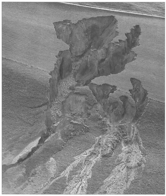
**Fig. 1:** Erosionsgräben und Teile des übermurten Geländes im Gebiet Hanebüel-Riedere. Luftaufnahme vom 26.8.2005.
