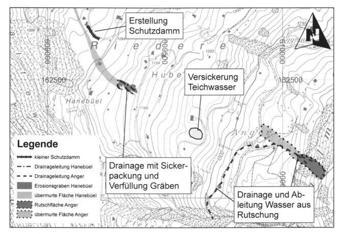
Fig. 12: Übersicht über die geplanten oder bereits ausgeführten Massnahmen im Gebiet Hanebüel bis Anger. Grundlage: Digitaler Übersichtsplan UP5; © Vermessungsamt des Kantons Bern.
