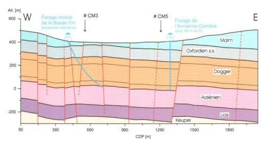
Fig. 2: Modèle géologique développé du profil sismique CM4, avec projection indicative du forage incliné de la Basse Fin (N°3)
