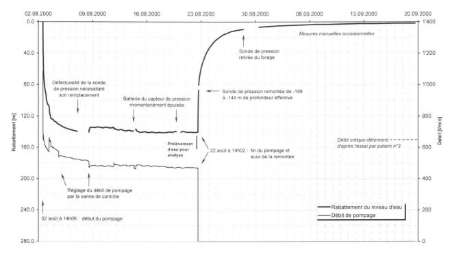
Fig. 6: Evolution du rabattement lors du pompage d'essai de longue durée réalisé en août 2000 dans le forage incliné de la Basse Fin, et remontée du niveau d'eau après arrêt de la pompe
