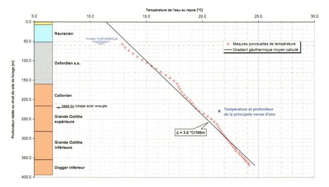
Fig. 8: Evolution de la température de l'eau dans le forage incliné de la Basse Fin en fonction de la profondeur réelle de la sonde de mesure (diagraphie du 11.07.2000 réalisée en régime hydrostatique)
