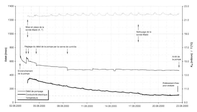
Fig. 7: Evolution de la température et de la conductivité des eaux captées lors du pompage d'essai de longue durée réalisé en août 2000 dans le forage incliné de la Basse Fin
