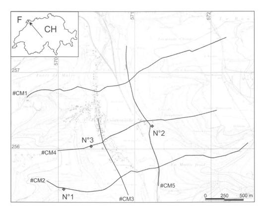
Fig. 1: Traces des profils sismiques réalisés et emplacements des trois forages de reconnaissance
