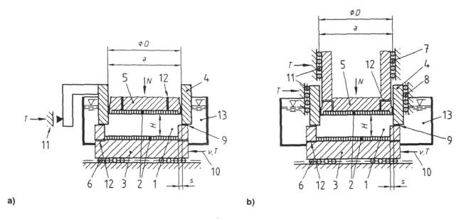
Fig. 3: Längsschnitt durch das Rahmenschergerät (DIN 18137-3)
