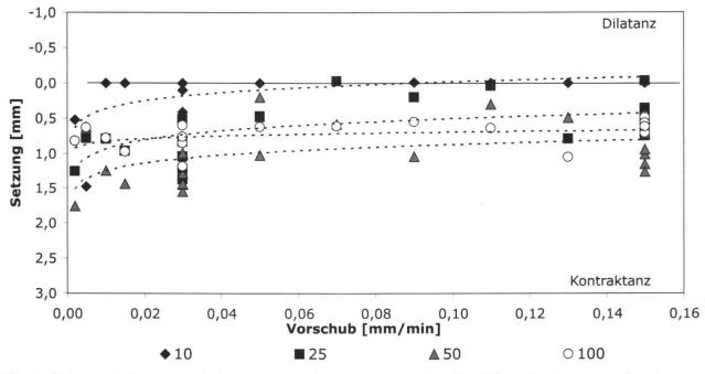
**Fig. 5:** Volumenänderungsverhalten: absolute Setzungsbeträge [mm] in Abhängigkeit von der Vorschubgeschwindigkeit [mm/min] bei unterschiedlichen Vertikalspannungen [kN/m²].
