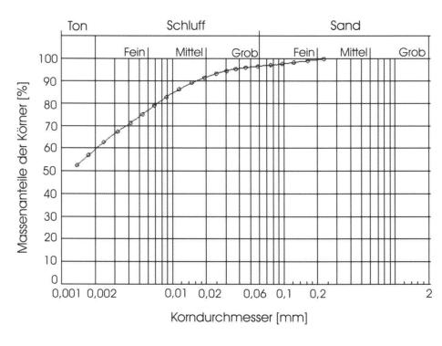
**Fig. 1:**Kornverteilungskurve des Tons.
