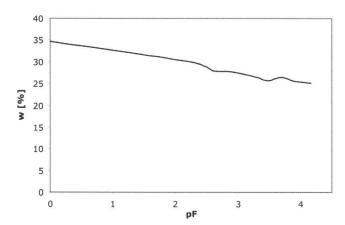
**Fig. 2:** p<sub>F</sub>-Kurve des untersuchten Tones.
