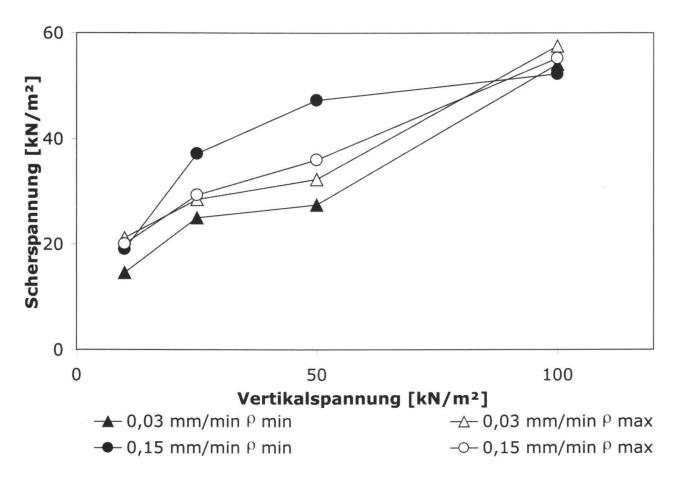
Fig. 6: Graphische Darstellung der maximalen Scherspannungen in Abhängigkeit von Vorschubgeschwindigkeit und Einbaudichte.
