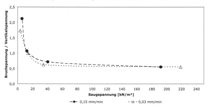
Fig. 7: Spannungen im Scherversuch.
