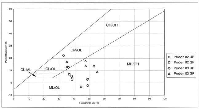
Fig. 10: Plastizitätsdiagramm aller Proben, Kreise: ungestörte Proben 02, Quadrate: gestörte Proben 02, Rhomben: ungestörte Proben 03, Dreiecke: gestörte Proben 03.
