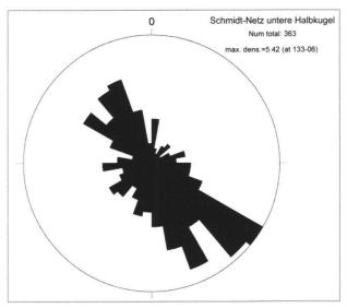
Fig. 7: Lineare (links) und Rosendiagramm (rechts) der Orientierung der Klastenlängsachsen aus allen Aufschlüssen.
