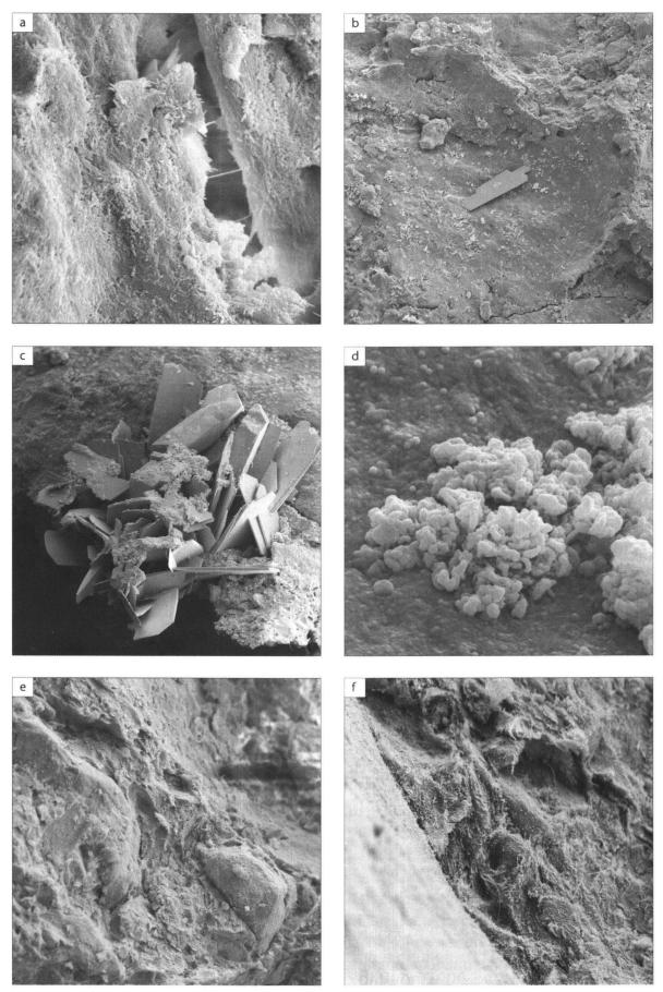
Fig. 12: Aufnahmen mit dem Rasterelektronenmikroskop. a: Grundmasse (Bildbreite 43 μm), b. Negativabdruck (Bildbreite 1744 μm), c: Idiomorphe Kristalle (Bildbreite 3792 μm), d: Blumenkohlartige Mineralausscheidung (Bildbreite 55 μm), e: Deformierte Grundmasse zwischen zwei Körnern (Bildbreite 329 μm), f: Deformierte Grundmasse im Kontaktbereich eines Korns (Bildbreite 22 μm).
