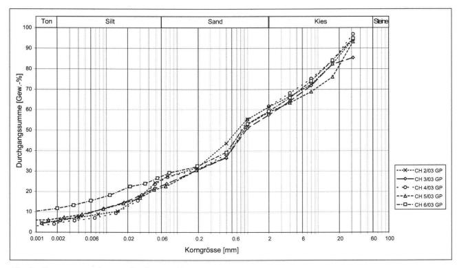
Fig. 9: Kornsummenkurven der Proben 03.
