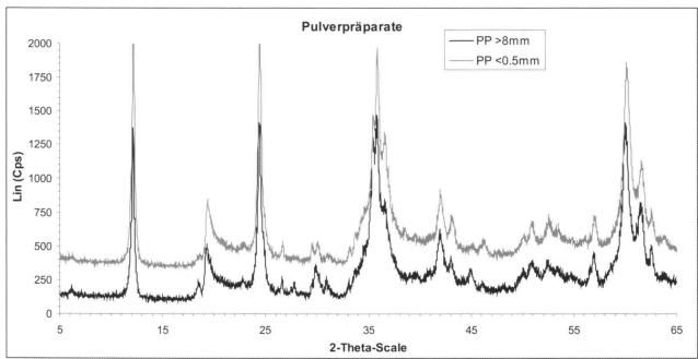
Fig. 13: Röntgendiffraktogramme der Textur- (oben) und Pulverpräparate (unten). Das Diffraktogramm der Kornfraktion <0.5mm (grau) ist leicht versetzt zum Diffraktogramm der Kornfraktion >8mm (schwarz) dargestellt. Die Diffraktogramme der Texturpräparate sind auf Antigorit normiert. Cu-Anode, Schrittweite 0,02° und Schrittzeit 3s.
