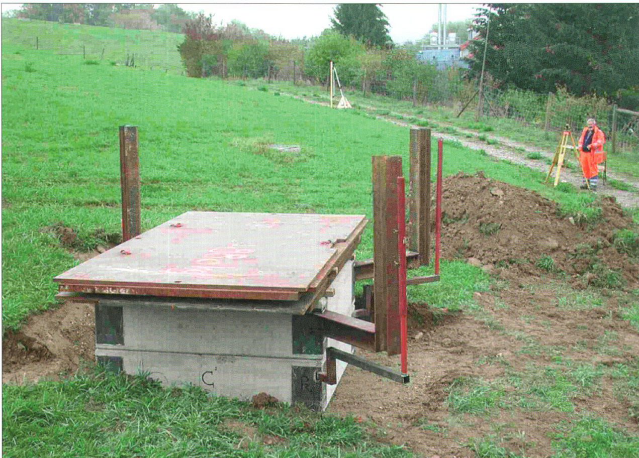
Fig. 1: Versuch Nr. 1 bei einer Last von 200 kN.
