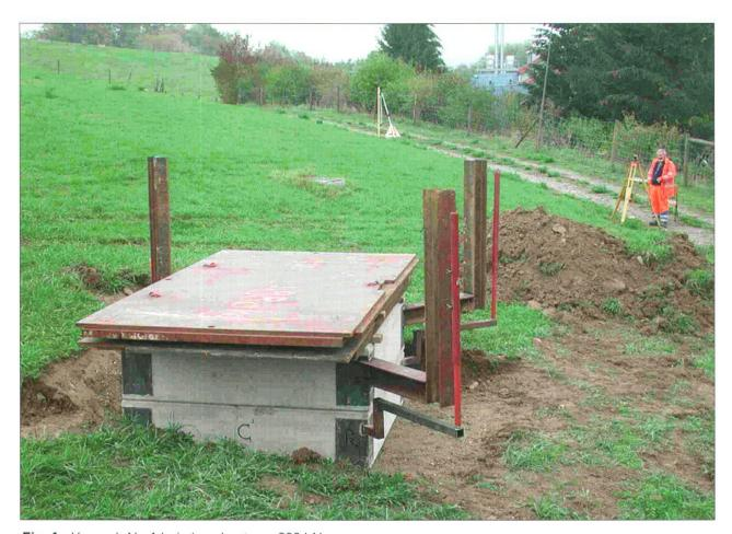
Fig. 1: Versuch Nr. 1 bei einer Last von 200 kN.
