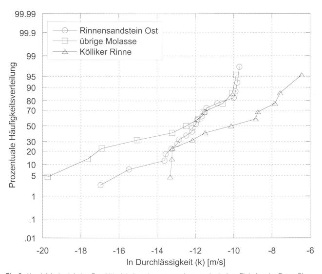
**Fig. 3:** Vergleich der lokalen Durchlässigkeiten der untersuchten geologischen Einheiten im Raum Obermatten.
