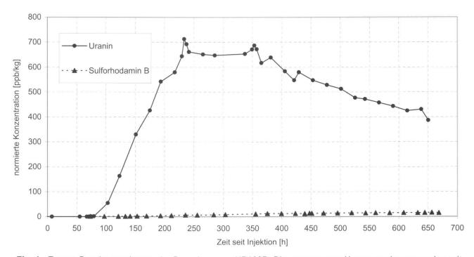
**Fig. 6:** Tracer-Durchgangskurven im Pumpbrunnen KB128B. Die gemessenen Konzentrationen wurden mit der eingeimpften Tracermenge normiert.
