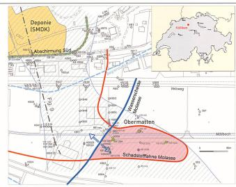
Fig. 8: Lageplan mit Deponie und Schadstofffahne im Molassefels. Blau schraffiert: Rinnensandstein Ost; rote Fläche: Fahne ausserhalb Zuströmbereich Abschirmung Süd; grüne Bohrungen: Pumpbrunnen für Pumpversuche; violette Bohrungen: Impfstellen beim Tracerversuch.
