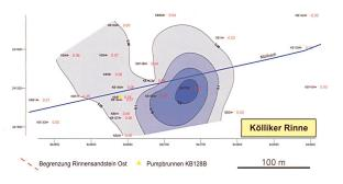
Fig. 13: Absenktrichter in der Molasse [Rinnensandstein Ost] und im Lockergestein der Kölliker Rinne nach 300h Pumpbetrieb in KB128B [Brunnen im Rinnensandstein mit Q=12 //min]. Die Darstellung erfolgt mittels Isolinien und Messwerten, welche die Potenzialreduktion in [m] darstellen. Masssstab: CH-Koordinatennetz.
