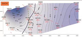
Fig. 10: Grundwasserpotenzialfläche für das Molassestockwerk im Raum Obermatten.
