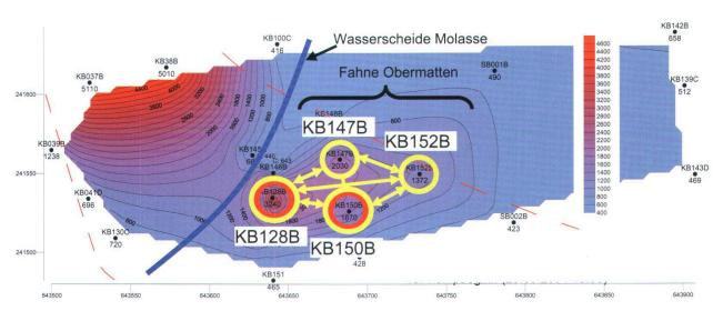
**Fig. 7:** Sanierungskonzept Rinnensandstein Ost Raum Obermatten. Rot: Pumpbrunnen 1. Etappe. Gelb: Brunnen mit alternierendem Pumpbetrieb während der 2. Etappe. Karte: El. Leitfähigkeit in der Molasse.
