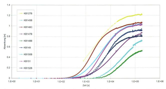
Fig. 5: Verlauf der Grundwasserpotenziale im Rinnensandstein Ost während Pumpversuch in KB128B, Versuchsdauer 53 h. Lage der Messstellen siehe Figur 8.
