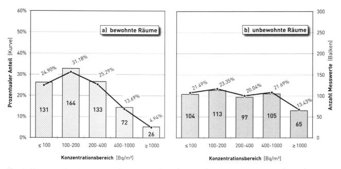
**Fig. 6:** Konzentrationsbereiche in a) bewohnten (links) sowie b) unbewohnten Räumen (rechts) der Gemeinden mit **hohem Radonrisiko.** Angabe der Anzahl Messwerte pro Konzentrationsbereich (Balken) und der prozentualen Anteile (Kurve).
