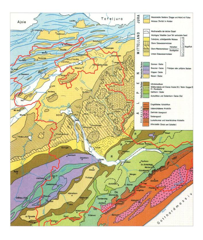
**Fig. 1:** Geologisch-tektonische Karte des Kantons Bern (Brüllhardt et al. 1981) mit Kantonsgrenze. Die Radonproblematik ist vor allem an die uranhaltigen Gesteine des Kristallins (Aarmassiv) und die durchlässigen Bereiche des Juras (Karst) gekoppelt.
