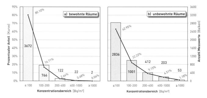
**Fig. 4:** Konzentrationsbereiche in a) bewohnten (links) sowie b) unbewohnten Räumen (rechts) der Gemeinden mit **geringem Radonrisiko.** Angabe der Anzahl Messwerte pro Konzentrationsbereich (Balken) und der prozentualen Anteile (Kurve).
