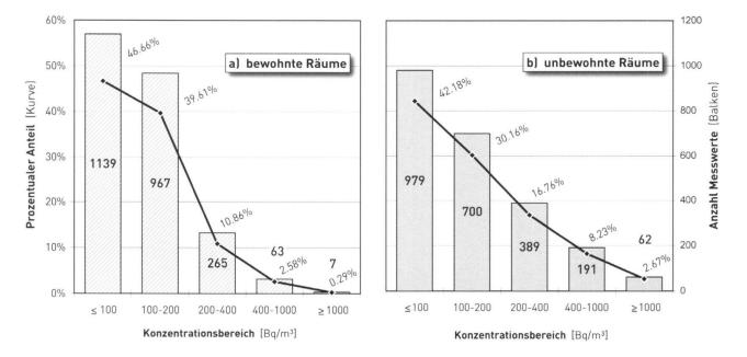
**Fig. 5:** Konzentrationsbereiche in a) bewohnten (links) sowie b) unbewohnten Räumen (rechts) der Gemeinden mit **mittlerem Radonrisiko.** Angabe der Anzahl Messwerte pro Konzentrationsbereich (Balken) und der prozentualen Anteile (Kurve).
