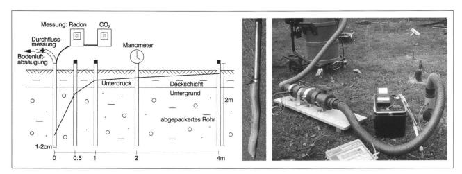
Fig. 3: Messanordnung für Permeabilitäts- und Radonmessung in Bodenluft; in der Mitte 2 m langes Messrohr mit Packer.
