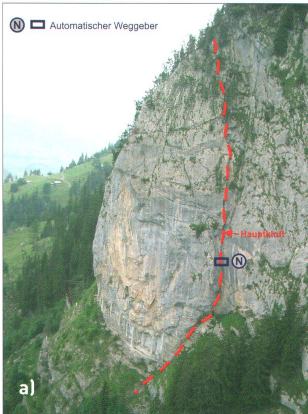
Fig. 2: a) Luftaufnahme der Felspartie Gstryfet Birg oberhalb der BLS-Linie bei Mitholz (Kt. Bern) von Norden. Eine z.T. weit offene Hauptklüft trennt ein rund 100'000 m 3 umfassendes, instabiles Felspaket von der stabilen Felsmasse (oben). b) Deformation und Temperatur des automatischen Weggebers «N» an der Hauptklüft des Gstryfet Birg (unten). Die Deformationskurve verläuft praktisch gleich wie die Temperaturkurve (Kluftausweitung bei kälteren Temperaturen). Die Niederschläge haben keine Auswirkungen auf die Bewegungen.
