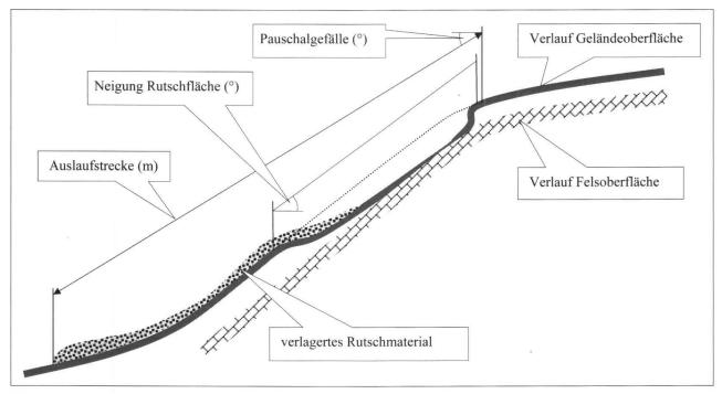
Fig. 9: Skizze eines Längenprofils durch eine Rutschfläche, wie sie besonders häufig im Perimeter Appenzell beobachtet wurde:
