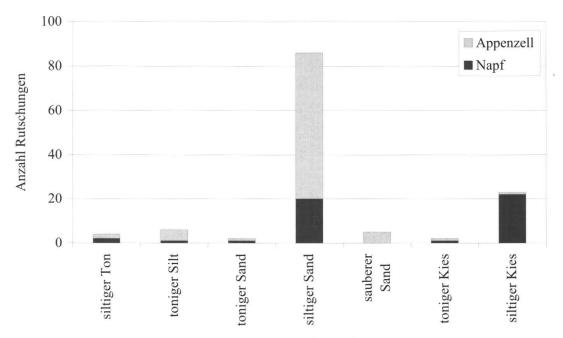
Fig. 7: Beurteilung der Lockergesteine im Feld nach VSS (1997a) am oberen Anrissrand der Rutschungen in den Untersuchungsbieten Napf und Appenzell.
