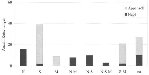
**Fig. 6:** Freigelegte Festgesteine in den Rutschflächen der Untersuchungsperimeter Napf und Appenzell. Abkürzungen: N = Nagelfluh, S = Sandstein, M = Mergel, N-M = Wechsellagerung Nagelfluh-Mergel, na = nicht aufgeschlossen.
