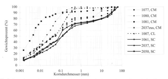
Fig. 8: Korngrössenanalyse von Lockergesteinsproben aus den Untersuchungsgebieten Napf und Appenzell. Legende: Angabe der Probennummer und Klassifikation nach USCS (VSS 1997b).
