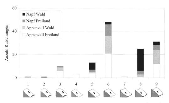
Fig. 5: Anzahl Wald- und Freilandrutschungen in den verschiedenen Geländeformen (1 bis 9). Typisierung der Geländeformen nach Geländewölbung sowohl in der Falllinie als auch senkrecht dazu. Die Geländeformen 3, 6 und 9 sind bezüglich der Hangfalllinie nach aussen gewölbt (Terrassen-/Buckelformen); die Geländeformen 7, 8 und 9 sind entlang der Höhenlinie nach innen gewölbt (Rinnen-/Muldenformen).
