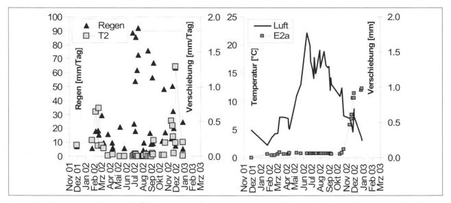
**Fig. 11:** Auch in der Periode 01/03 bewirkten die Sommerniederschläge keine Verschiebungen. Verglichen zu den Telejointmetern an der Felsoberfläche setzten die Verschiebungen in 10 m Tiefe rund 1 Monat später ein (Extensometer E2a).
