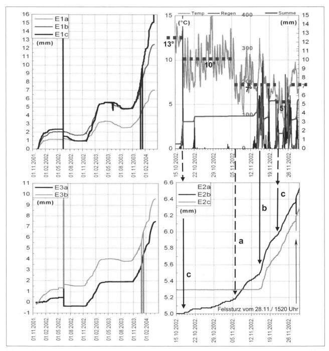
**Fig. 7:** Die Extensometer zeigen ab November zu- und im Sommer stagnierende bis leicht abnehmende Verschiebungen. Grössere Temperaturabsenkungen injizieren Verschiebungsschübe (a), starke Niederschläge bei gleicher Lufttemperatur ebenfalls (b), wie auch Überlagerungen von beiden (c).
