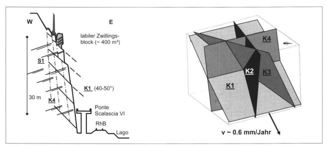
Fig. 18: Lage der Felstrennflächen im Schnitt und im Blockdiagramm. Die Felsentfestigung erfolgt durch Ablösung entlang der K4, K2 und K3 Klüfte und der Gleitfläche K1 mit 40–50° Neigung.
