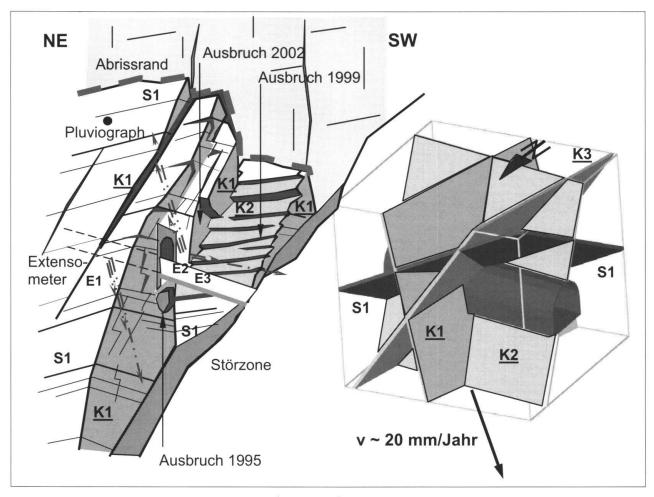
Fig. 4: Die Felsablösung erfolgt entlang K1 (überkippt), von S1 und den versetzten Gleitflächen K2 mit bis 65° Neigung.
