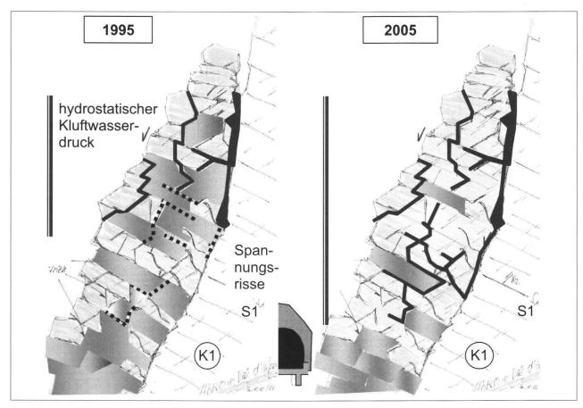
Fig. 12: Schnitt durch die kritische Sturzmasse mit Entfestigungsmodell. Spannungsumlagerungen führen über Jahrzehnte zu Spannungsrissen, zur Öffnung von Kluftwasserwegen, zur Zunahme des hydrostatischen Kluftwasserdrucks, zum Abbau der Kohäsion und zu Gesteinszonen erhöhter Spannungszustände (dargestellt als «undulierende» Zonen).
