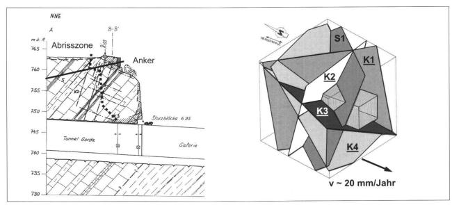
**Fig. 15:** Schnitt durch die Tunnelachse mit der Abrisszone. Die Felstrennflächen im Blockdiagramm zeigen die Felsablösung entlang der K2/K1 Klüfte und der Gleitfläche K4 mit 50° Neigung Richtung Süd.
