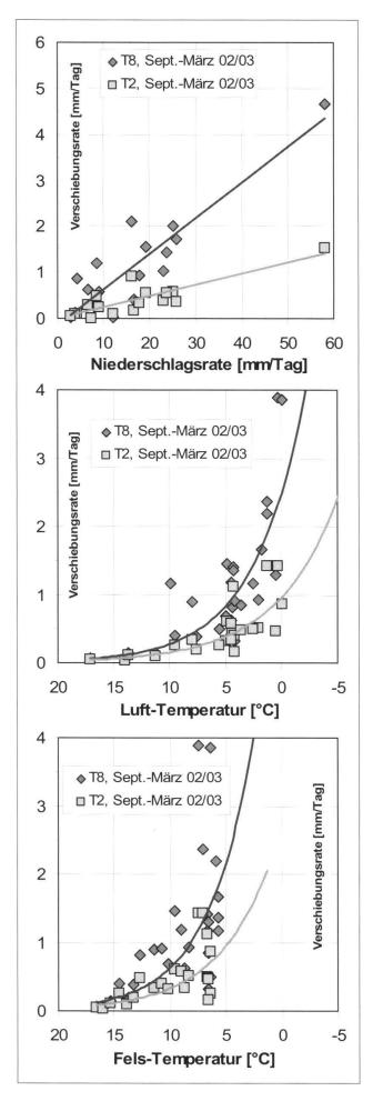
Fig. 9: Der Einfluss der Niederschläge auf die Verschiebungen ist eher linear. Jener der Temperatur verläuft exponentiell (oben nur Regen-, Mitte und unten nur Trockenperioden dargestellt).
