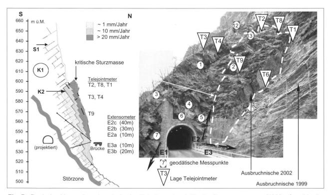
**Fig. 5:** Dank der Messanlage konnte in der Felsrippe eine kritische Sturzmasse von ~3'000 m³ und in die Felstiefe Entfestigungszonen mit abnehmenden Verschiebungsraten erkannt werden.
