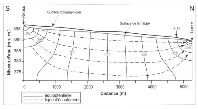
Fig. 6: Représentation simulée de l'écoulement en coupe verticale le long de l'axe principal de l'aquifère. Situation de la coupe : voir figure 2.
