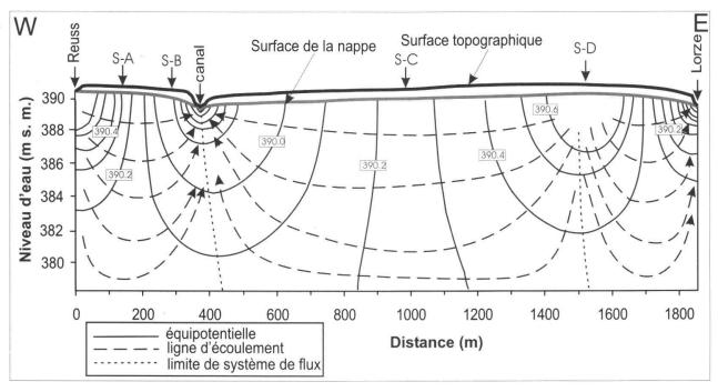
Fig. 5: Représentation simulée des écoulements en coupe verticale perpendiculaire à l'axe principal de l'aquifère. Situation de la coupe : voir figure 2.
