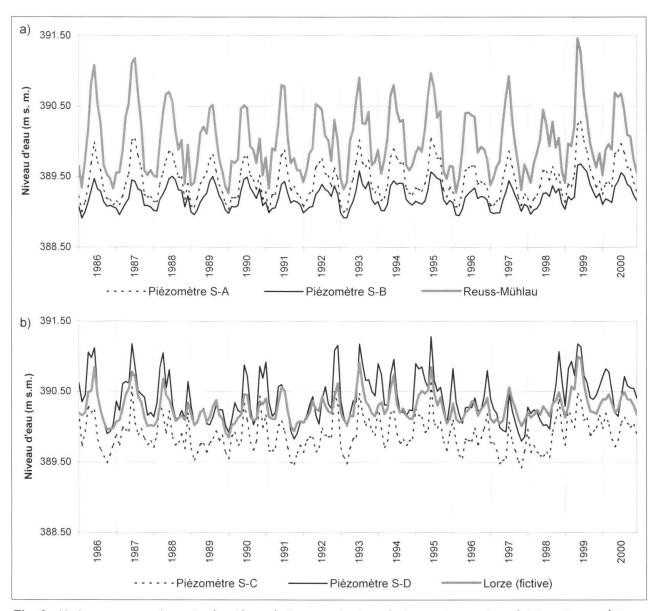
Fig. 3: Hydrogrammes des relevés piézométriques et hydrométriques des stations à Hünenberg. a) Zone de l'aquifère entre la Reuss et le canal de drainage, b) Zone de l'aquifère entre le canal et la Lorze.
