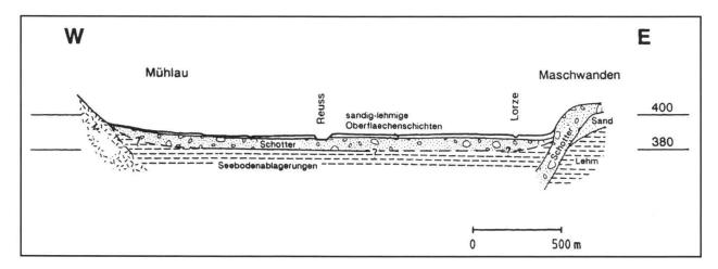
Fig. 1: Profil géologique schématique perpendiculaire à la direction de l'écoulement, 1,5 km au nord de Stadelmatt, selon Jäckli & Kempf (1972).
