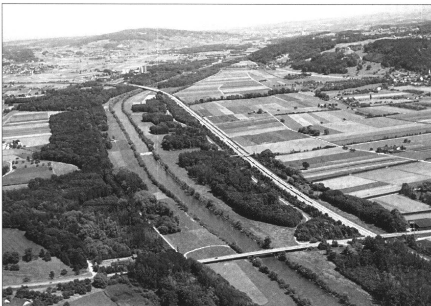
Fig. 3: Heutiger Thurlauf bei Pfylen (Blick flussaufwärts): Begradigtes Mittelgerinne, begleitet von Ufergehölzstreifen, Hochwasserdamm, Binnenkanal und Autobahn. Das Vorland wird land- und forstwirtschaftlich genutzt. Foto Chr. Herrmann, BHAtteam, Frauenfeld
