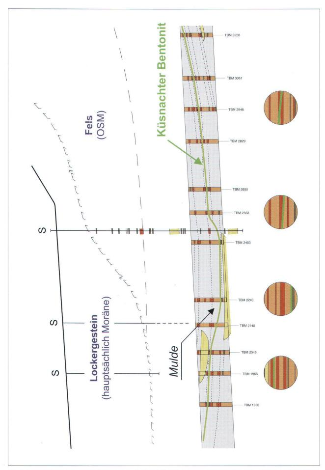
**Fig. 5** Geologisches Längenprofil (überhöht) im Gebiet Wollishofen, jenem Streckenabschnitt auf dem der Küsnachter Bentonit durchörtert wurde (S=Sondierung). Die Mulde in der linken Bildhälfte entspricht dem Geländerelief zur Zeit der Ablagerung des vulkankischen Aschehorizonts.
