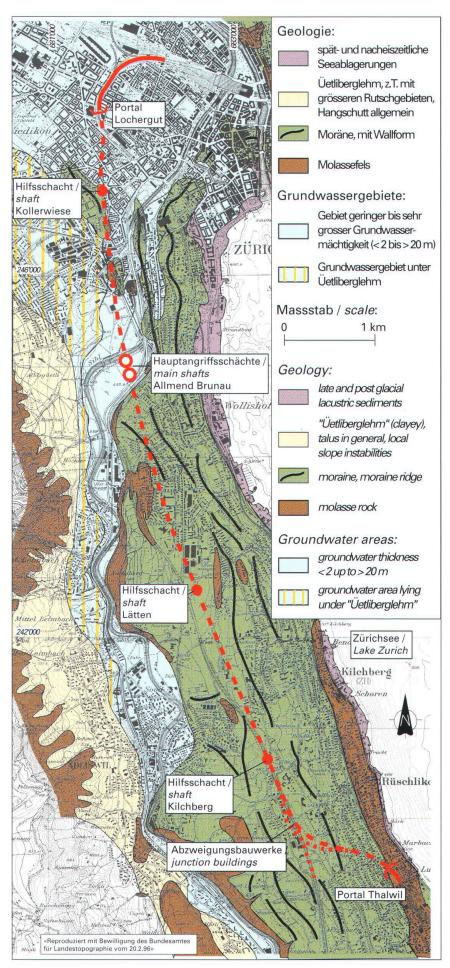
**Fig. 1** Geologische Situation der 9.2 km langen Eisenbahnstrecke Zürich-Thalwil, welche zwischen 1997 und 2003 als erster Teil des Zimmerberg-Basistunnels realisiert wurde.
