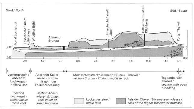
Fig. 2 Geologisches Gesamtlängenprofil der Eisenbahnstrecke Zürich-Thalwil.
