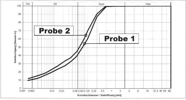
**Fig. 3:** Die Korngrössenanalysen belegen den hohen Feinanteil um rund 45% des sandigen Kolluviums. Probe 1 wurde dem Anrissgebiet von Mure Nr. 1 entnommen, Probe 2 bei Mure Nr. 2.
