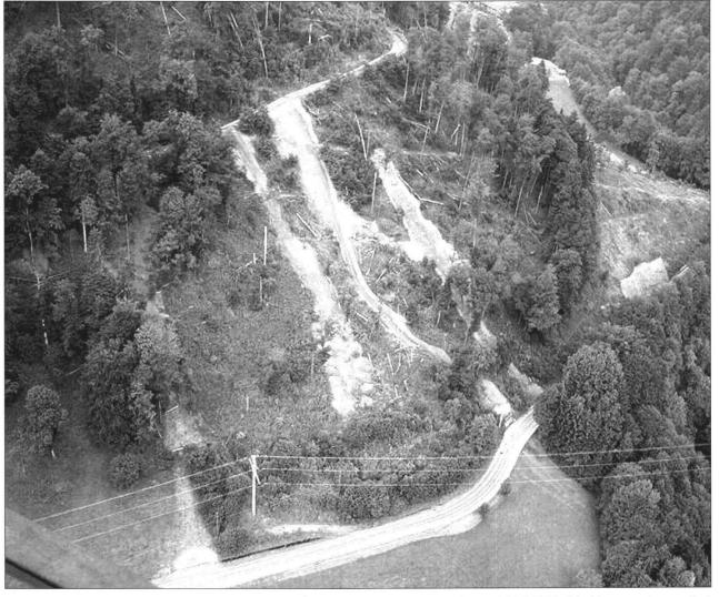
Fig. 6: Flugaufnahme der Muren Nr. 1, 2, 3, und 6 (von rechts W nach links 0) vom 25.06.2003. Die Murgangrinnen sind bereits ausgeräumt und mit Kokosmatten befestigt.
