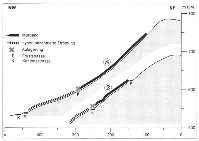
**Fig. 2:** Geländeprofile entlang der Muren Nr. 2 und Nr. 8. Bei den Geländeknicken der Strassen erfolgte meist eine teilweise Sedimentation, so dass sich der Rest als hyperkonzentrierte Strömung weiter talwärts ergoss.
