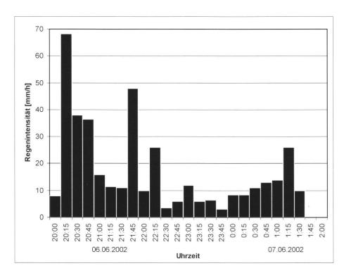
Fig. 5: Histogramm der viertelstündlich aufgezeichneten Regenintensitäten des Wolkenbruchs vom 6./7. Juni 2003 der Station Littau (Quelle Strasseninspektorat des Kantons Luzern).
