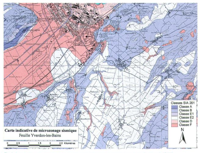
Fig. 3: Extrait de la carte indicative de microzonage sismique de la feuille Yverdon-les-Bains au 1: 25'000.
