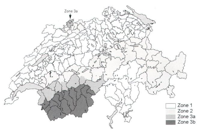
Fig. 2: Carte des zones d'aléa sismique de la Suisse selon la norme SIA 261.
