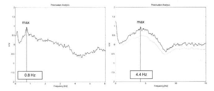
Fig. 4: Représentation du spectre H/V moyen et détermination graphique de la fréquence propre en deux points d'acquisition:
