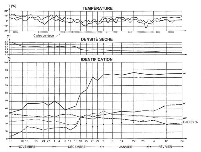
Fig. 5: Caractéristiques géotechniques des schistes cartons: w = teneur en eau,  $w_L = limite$  de liquidité,  $w_P = limite$  de plasticité. Le diagramme résume l'évolution du matériau et son altération entre le 2.11.1975 et le 23.2.1976. Il est très révélateur du changement d'état du matériau qui évolue rapidement lorsque la teneur en carbonates est inférieure à 30 % (valeur critique; Broquet 1980).
