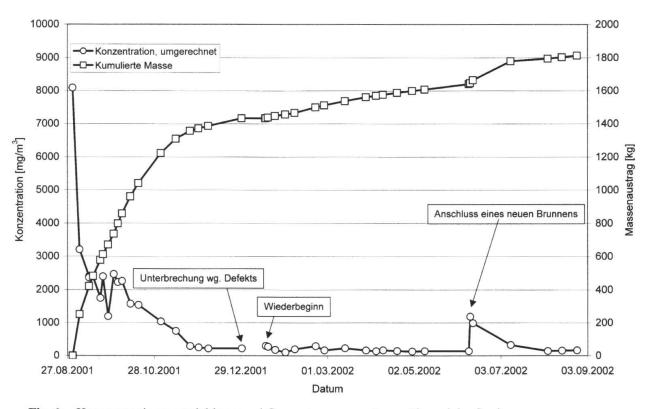
Fig. 6: Konzentrationsentwicklung und Gesamtmassenaustrag während der Sanierung.
