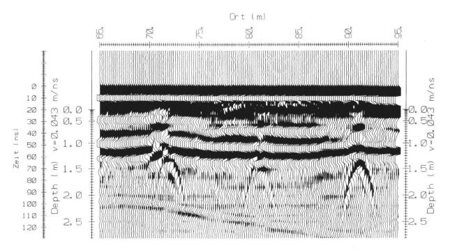
**Fig. 13:** Ortung von Leitungen (bilden sich in Radargrammen als Hyperbeln ab) bei der Deponie Riet. Das Radarprofil wurde in einer Feuchtwiese aufgenommen. Das Material dieser Leitungen ist nicht bekannt.
