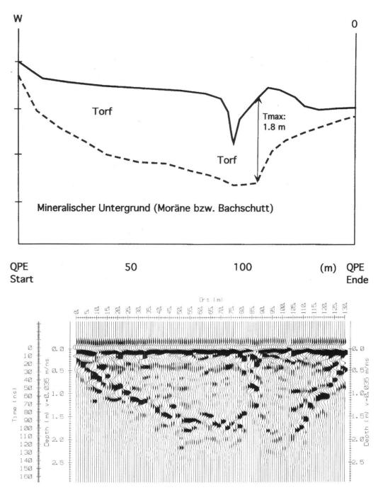
**Fig. 10:** Radargramm einer Messung (unten), das einen West-Ost Schnitt durch das Zigermoos darstellt. Die Basisfläche des Moors ist sehr gut zu erkennen. Im darüber liegenden Diagramm sind die Messdaten zusammen mit den Höhendaten in die Torfmächtigkeit umgewandelt worden.
