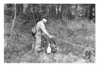
**Fig. 7:** Georadar in unwegsamen Gelände: Antennenführer mit Messband (Foto: P. Staubli).
