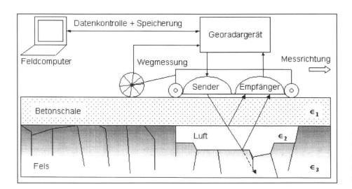
Fig. 4: Georadarverfahren mit weitgehend automatisierter Messwertaufnahme.
