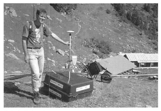
**Fig. 5:** Positionierung der Georadarantennen mit differentiellem GPS beim Bergsturzgebiet Chapf, Innertkirchen (ETH Zürich, Geodätischer Projektkurs).
