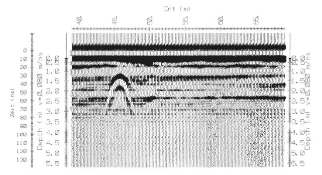
Fig. 12: Geortete Gasleitung (Hyperbel) bei der Deponie Riet.
