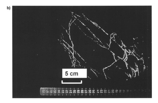
**Fig. 4:** Kluftnetzwerk in der Auflockerungszone: a) Auflockerungsklüfte in der seitlichen Wand des Erkundungsstollens; b) Harzimprägnierte Auflockerungsklüfte in einem aufgeschnittenen Bohrkern.
