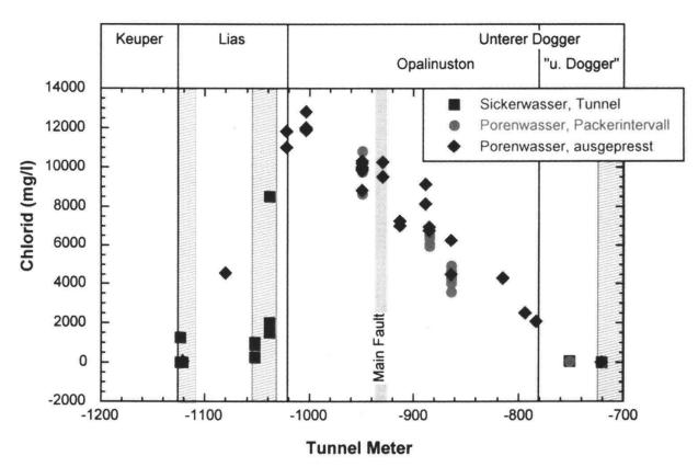
**Fig. 5:** Mont-Terri-Erkundungsstollen: Verteilung von Chloridgehalten in Grundwasser, Porenwasser aus Packerintervallen in Bohrungen und aus Bohrkernen ausgepresstem Porenwasser entlang des Tunnels (Zonen mit erhöhter hydraulischer Durchlässigkeit sind blau schraffiert), nach Pearson et al. 2002.
