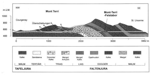
Fig. 2: Geologisches Profil längs des Mont-Terri-Autobahntunnels.
