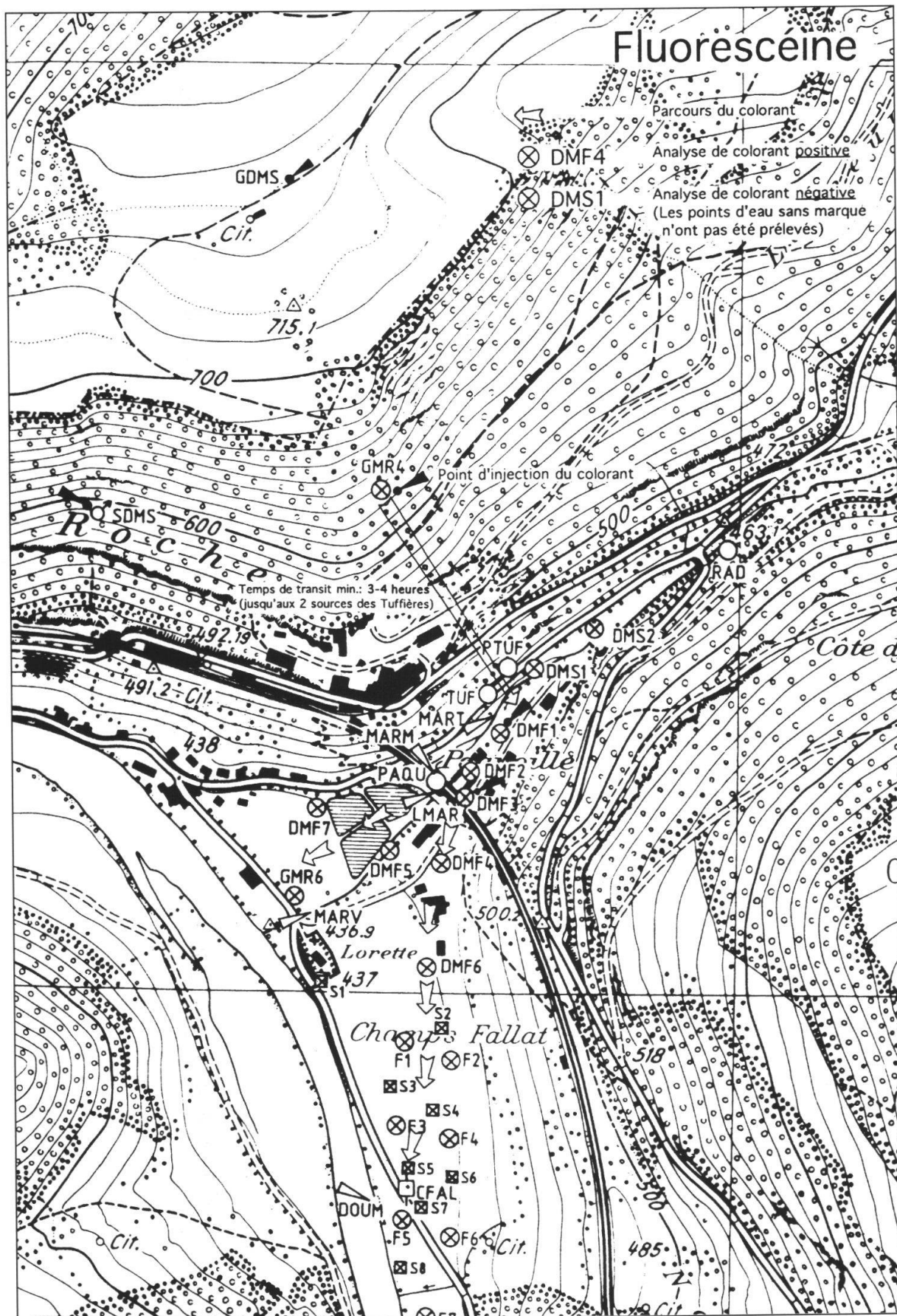
Fig. 3: Färbversuch Herbst 1995, Tracer Fluorescein (aus MFR 1996).
