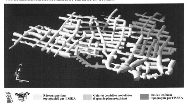
**Fig. 2:** 3D-Modellaufnahme des Bergwerks St.-Ursanne, Endzustand und Verfüllungszustand März 2000 (aus ISSKA 2000).
