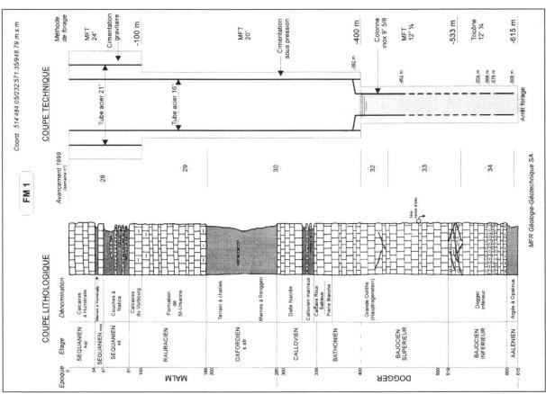
Fig. 4: Coupes lithologiques et techniques des forages FM1 et FM2.
