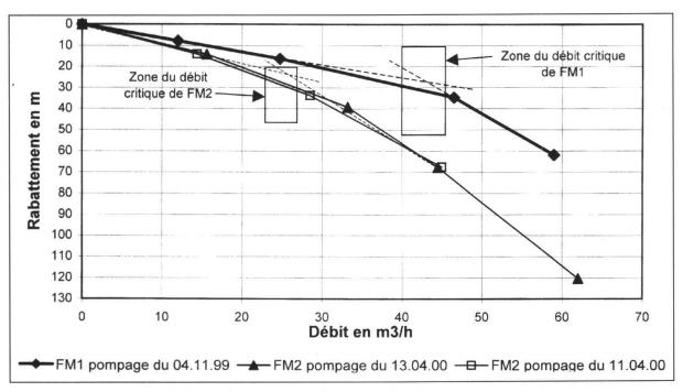
Fig. 5: Courbes caractéristiques des forages FM1 et FM2 à Muriaux.
