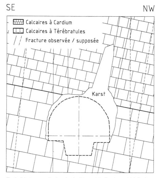
Fig. 6: Développement d'un karst dans les Calcaires à Cardium du tunnel de la Perche
