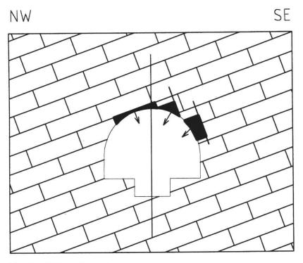
Fig. 8: Schéma d'instabilité potentielle.
