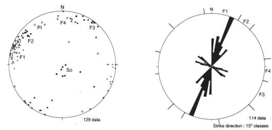
**Fig. 5:** En haut, tableau des caractéristiques structurales des discontinuités sur affleurement. En bas à gauche, projection stéréographique de Schmidt-Lambert, hémisphère inférieur. So: stratification, F1 à F4: familles de fractures, PI: plan isolé. En bas à droite, répartition statistique des discontinuités subverticales sous la forme d'un diagramme en rose.
