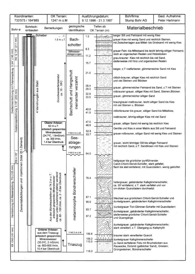
Fig. 4: Geologisches Profil der Sondierbohrung (vereinfacht).
