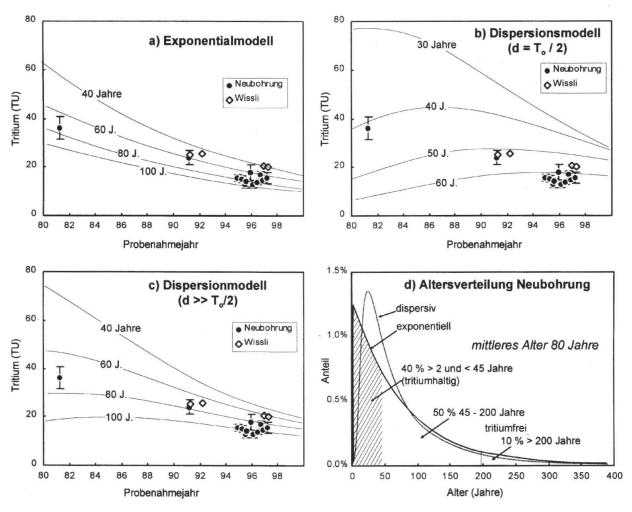
Fig. 11: Vergleich der Tritium-Messdaten (NB und Wissli) mit einem Exponentialmodell (a), einem einfachem Dispersionsmodell (b) und einem Dispersionsmodell mit hoher Dispersion (c). Die Grafik d) zeigt die exponentielle (und scheinbar dispersive) Altersverteilung der Neubohrung mit einer mittleren Verweilzeit von 80 Jahren.
