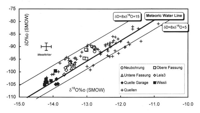
Fig. 7: δD - δ<sup>18</sup>O-Diagramm. Durch die Niederschläge wird die lokale Niederschlagsgerade (Meteoric Water Line MWL) bestimmt. Die Mineralquellen liegen alle nahe bei der MWL, so dass Wasser/Gesteinsinteraktionen auszuschliessen sind.
