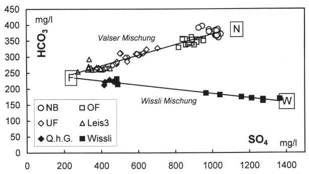
**Fig. 5:** Bei den Mineralquellen von Vals können zwei Mischungsreihen aus drei Endgliedern abgeleitet werden: Das Endglied «Felswasser» (F) hat einen SO<sub>4</sub>-Gehalt von rund 200–250 mg/l und mischt sich bei der *Valser Mischung* (NB, OF, UF, Leis 3) mit dem Endglied «Neubohrung» (N) und bei der *Wissli Mischung* (Wissliquelle, Q.h.G.) mit dem Endglied «Wissli» (W).
