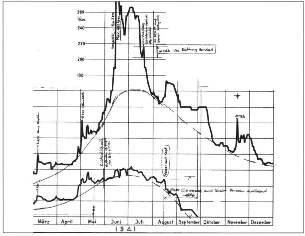
**Fig. 4:** Zulaufstollen Handeck-Chapf: Wasserausfluss Baufenster Benzlaui (nach Pflugshaupt & Grunder 1941).
