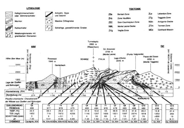
**Fig. 1:** Geologisches Profil entlang des Simplontunnels mit Lage der beprobten Quellen und Bohrungen und deren hauptsächlichen physiko-chemischen Parametern (aus Bianchetti et al. 1993).
