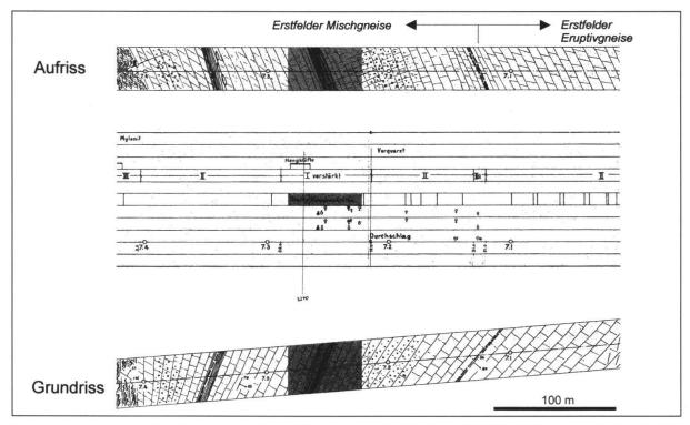
**Fig. 3:** Ausschnitt aus dem geologisch-petrographischen Profil des Zulaufstollens Handeck-Chapf mit Lage der starken Wassereinbrüche (nach Pflugshaupt & Grunder 1941).
