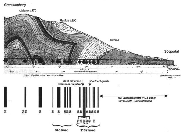
**Fig. 2:** Ausschnitt aus dem geologischen Profil des Grenchenbergtunnels mit Angabe der Wassereintritte und Schüttungen in I/sec (aus Buxtorf & Troesch 1917, ergänzt).
