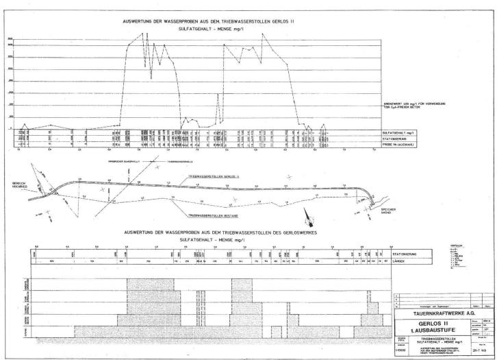
**Fig. 4:** Auswertung der Wasserproben aus dem Triebwasserstollen des Gerloswerkes und des Stollen Gerlos II: Sulfatgehalte.
