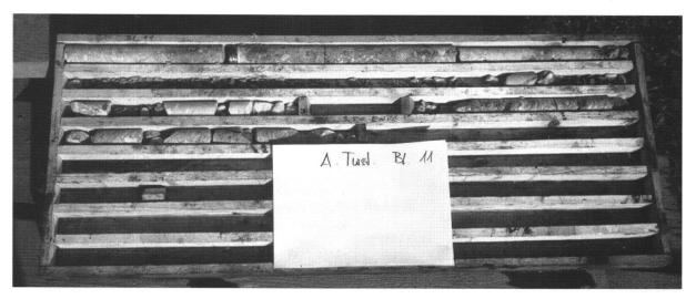
Fig. 5: Bohrkern durch Betonring, Blechverkleidung, ursprünglicher Beton und gipsführendes Gebirge.
