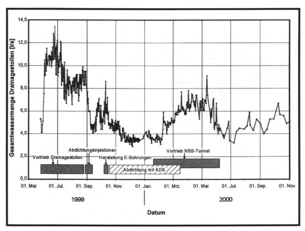
**Fig. 7:** Zeitliche Entwicklung der im Drainagestollen angefallenen Gesamtwassermenge (zwischen Mai 1999 und November 2000).
