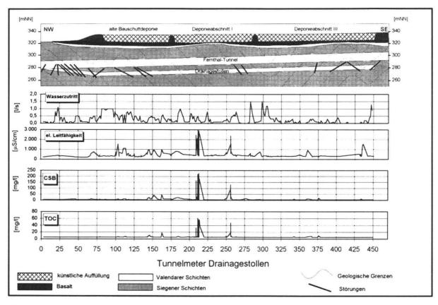
**Fig. 6:** Schematisches Längsprofil des Drainagestollens mit Angabe der zutretenden Wassermengen sowie Analysenergebnissen der Parameter elektrische Leitfähigkeit, CSB und TOC.
