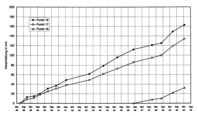
Fig. 4: Gesamtverschiebung 1988 bis 1999 ausgewählter Messpunkte.
