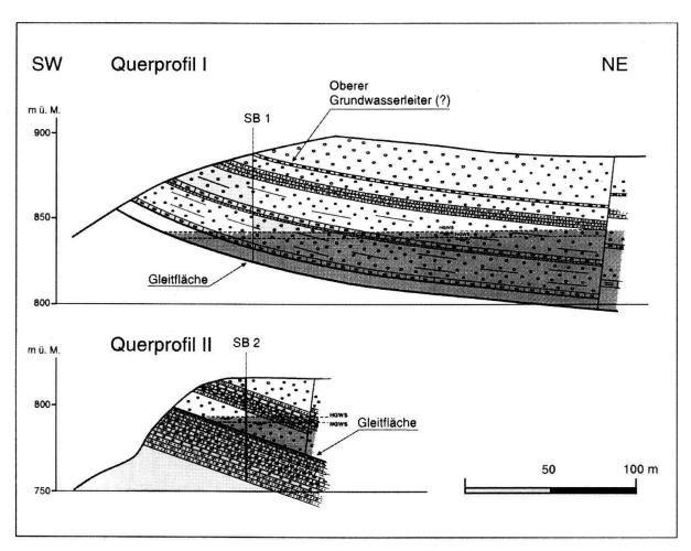
Fig. 3: Schematische Querprofile durch die Felsrutschung.
