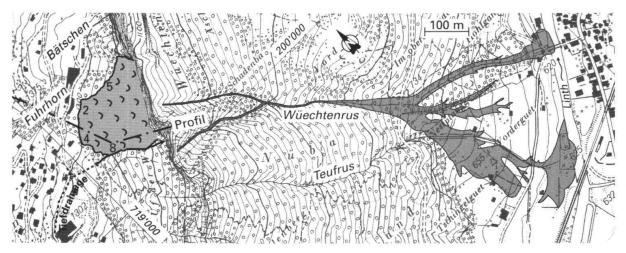
**Fig. 1:** Übersichtskarte mit Rutschung "Bätschen" und Murgängen in der Wüechtenrus, Entwässerungsstollen mit oberflächlicher Ableitung und Lage geologischer Schnitt (Fig. 3), reproduziert mit Bewilligung der Übersichtsplanstelle des Kt. Glarus vom 3. März 2000.
