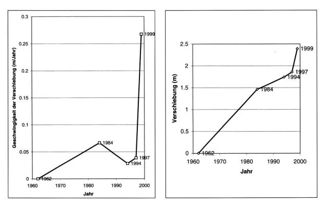
Fig. 4: Die Verschiebung des Triangulationspunktes T2 seit 1962. Azimut der Verschiebung: 99°.
