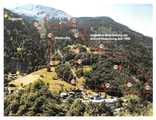
Fig. 1: Blick von Osten (Basisstation Distanzmessungen 853.16 m ü.M.) auf das Rutschgebiet Gryfenbach.
