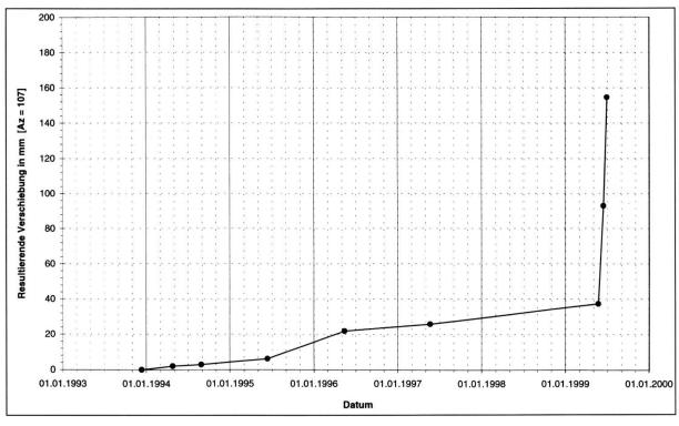
**Fig. 5:** Die Verschiebung der 58 m mächtigen Rutschmasse bei Inklinometer 93.03 seit 1993: Azimut der Verschiebung: 112°.
